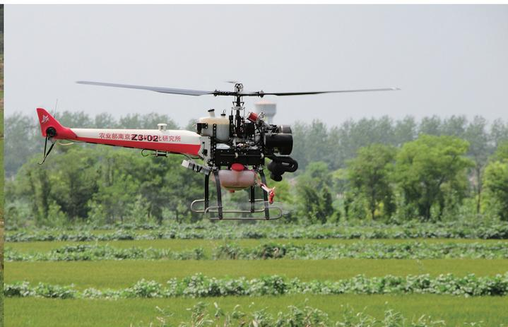
无人驾驶自动导航低空施药技术: 南京农机所薛新宇科研团队融合农用轻型航空运载平台技术、GPS自动导航技术、超低空低量抗漂移施药技术等多项高新技术, 研发出无人驾驶自动导航低空施药技术及装备为我国航空植保高效作业提供了全新的施药技术与设备, 具有高精度GPS自动导航, 喷幅对接精度达亚米级, 其作业效率是地面机具的100至150倍, 可将农药有效利用率提高10%至20%。
